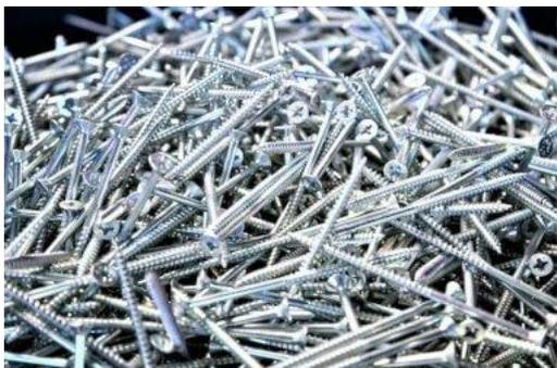
Processo indicato per minuteria metallica e per particolari di **piccole/modeste dimensioni e peso**, i quali possono subire l'azione meccanica di movimento nel singolo barile, senza che vengano provocati danneggiamenti o deformazioni dei metalli stessi.
